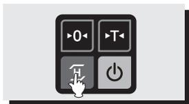
1. Deposite un peso sobre el plato. Para activar la función del cálculo de nivel promedio de un peso fluctuante (pesaje de animales), pulse la tecla **H**.
