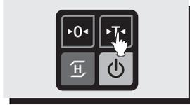
2. Drücken sie die ►T◄-Taste um den Null-Punkt zu setzen.
