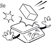
Zum Transportieren immer unter die Waage fassen. Niemals an der Platte oder am Stativ tragen.
