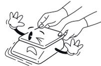
Batterien immer aus der Waage nehmen, wenn diese längere Zeit nicht benutzt wird. Beschädigungen durch ein etwaiges Auslaufen können so verhindert werden.
