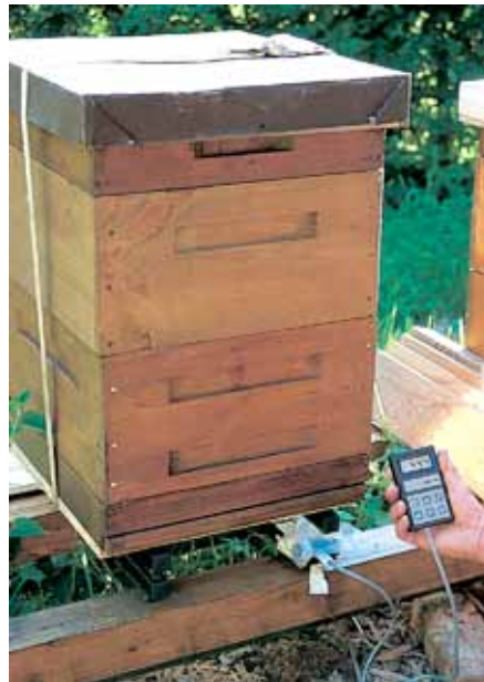
Bei der Zeidler-Memo-Waage von Manfred Raff konnte man bereits 1997 die Daten mit einem Anzeigedisplays oder einem Laptop auslesen.
